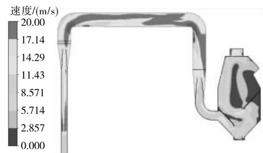
图18 1/16壳仁分离系统中部截面流场速度云图
