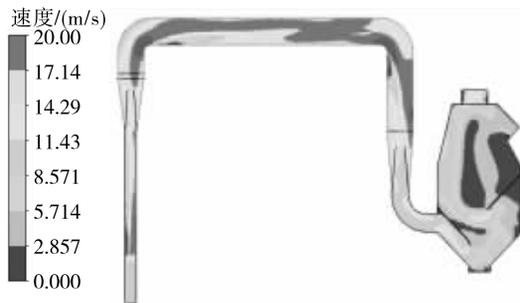
图16 1/4壳仁分离系统中部截面流场速度云图
