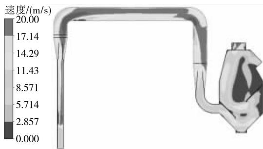
图15 1/2壳仁分离系统中部截面流场速度云图
