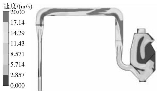
图17 1/8壳仁分离系统中部截面流场速度云图
