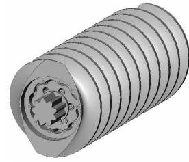
图 4 同轴异速单螺杆内部结构
