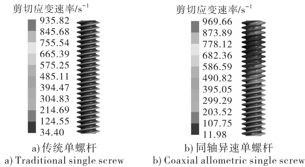
图12 2种单螺杆的剪切应变速率
