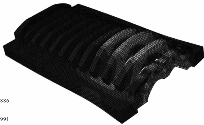
(a)原榨笼Mises应力云图
