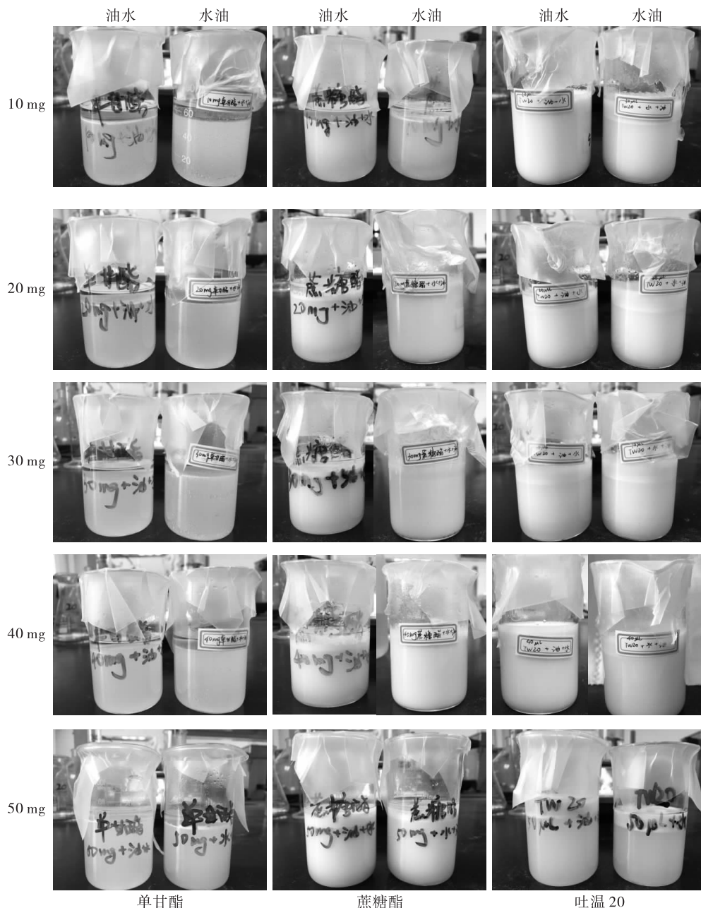
图 1 添加单甘酯、蔗糖酯和吐温 20 橄榄油乳液的静置分层情况
