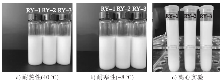
图 2 3 种护肤乳液的稳定性测试结果
