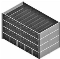
图3 烘干段和缓苏段结构
