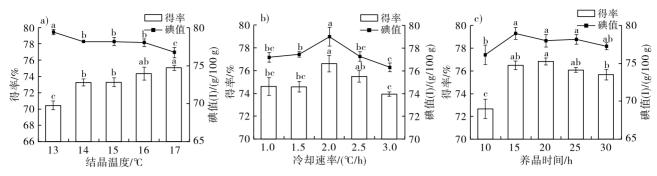
注:基础条件为冷却速率 2 ℃/h、结晶温度 16 ℃、养晶时间 15 h
