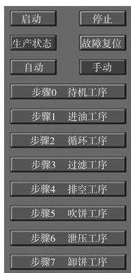
图2 单机工序控制界面
