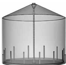
图6 中心管径向通风技术示意图
